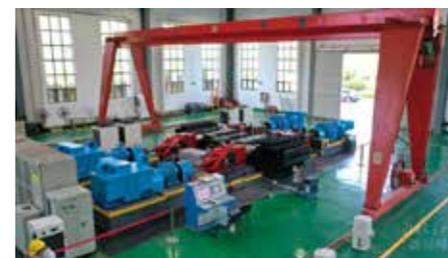
国际上首个1MW超导感应加热器
